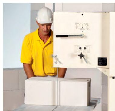
Резка с использованием ленточной пилы
